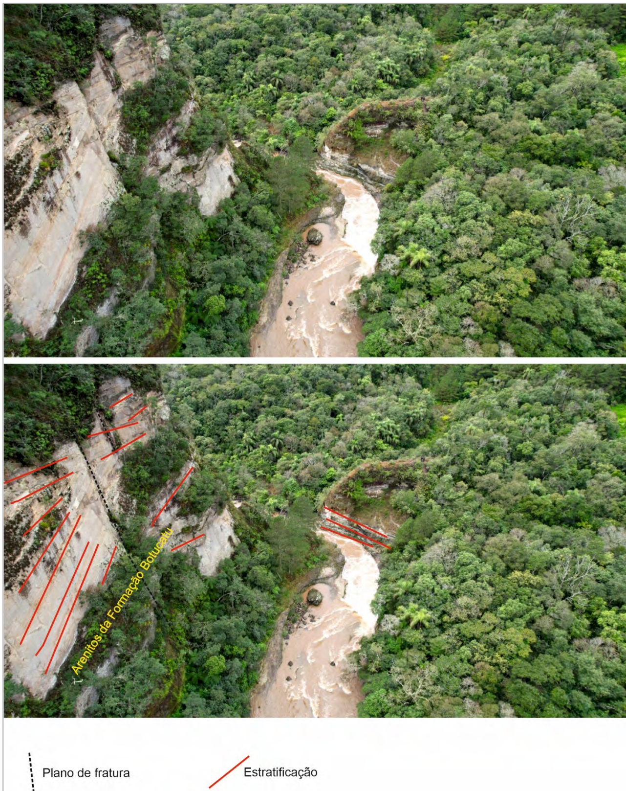
FOTO 198 - ESTRUTURAS IDENTIFICADAS NO PAREDÃO ROCHOSO NA ÁREA DE INFLUÊNCIA DA PCH PAREDINHA FONTE: GEOPAC, FÁBIO MANASSÉS, 2023
