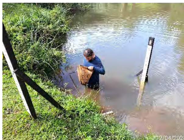
FOTO 37 – AMOSTRADOR DO TIPO PUÇÁ (DIP NET) UTILIZADO PARA A CAPTURA DOS MACROINVERTEBRADOS AQUÁTICOS NOS PONTOS AMOSTRADOS DA PCH PAREDINHA FONTE: ROGER H. DALCIN, 2023
