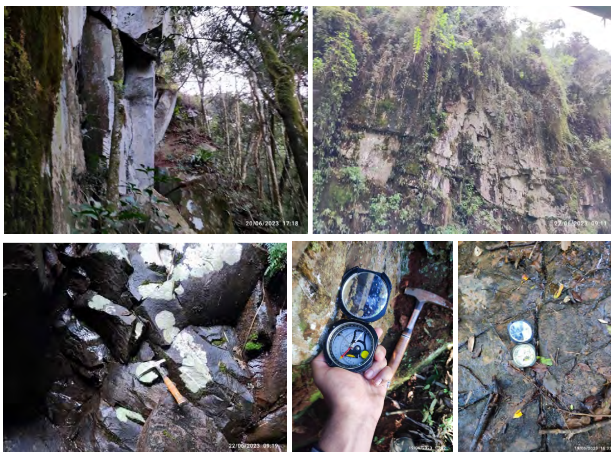
FOTO 25 - FRATURAS IDENTIFICADAS NO BASALTO FONTE: FÁBIO MANASSÉS, 2023
