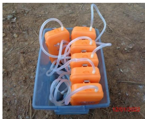
FOTO 12 – EXEMPLO DE AERADORES PORTÁTEIS UTILIZADOS PARA OXIGENAÇÃO TEMPORÁRIA FONTE: AMBIOTECH, 2022
