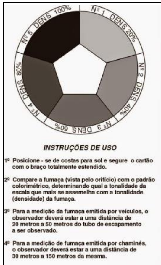
FIGURA 5 – ESCALA DE RINGELMANN E INSTRUÇÕES DE USO FONTE: CETESB, 2019
